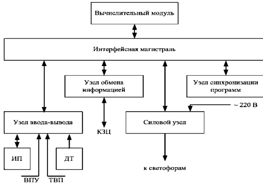
Рис. 1. Обобщенная схема автоматизированной системы управления транспортными потоками на перекрестке
