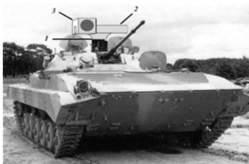
Рис. 4. Детонаційний лазер на шасі бронееоб'єкта: 1 – кріплення; 2 – детонаційна труба; 3 – зона оптичного резонатора
