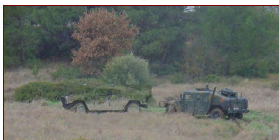
Рис. 8. Варіант покриття серії Chameleon компанії Intermat: а – варіант фарбування; б – порівняння сигналів автомобілів з покриттям і без покриття
