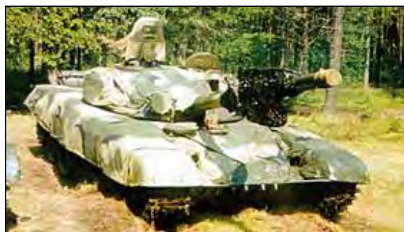
Рис. 3. Танк Т-72, оснащенный маскировочным комплектом «Накидка» (разработка НИИ Стали, РФ, вероятность обнаружения танка в ближнем ИК-диапазоне дневными и ночными приборами и прицелами, тепловизионными системами и головками самонаведения (ГСН) снижается на 30%; в тепловом диапазоне вероятность обнаружения и захвата танка инфракрасными ГСН снижается в 2 – 3 раза; резко снижается заметность танка в радиотепловом диапазоне – температура танка с маскировкой и фона практически совпадают; в радиолокационном диапазоне вероятность и дальность обнаружения оснащенного «Накидкой» танка снижется в шесть и более раз)
