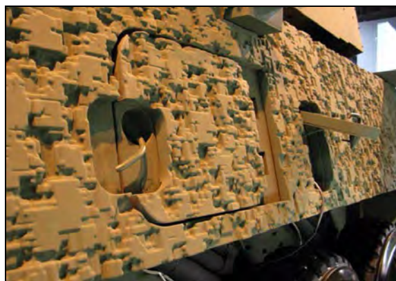
Рис. 7. Інноваційний накладний 3D камуфляж TactiCam (покриває може застосовуватися з іншими матеріалами, поглинаючими/знижуючими інфрачервоний або радіолокаційний випромінювання, а також може заповнюватися ізоляційним матеріалом, який зменшує власне теплове випромінювання і нагрів від надлишкового сонячного тепла)
