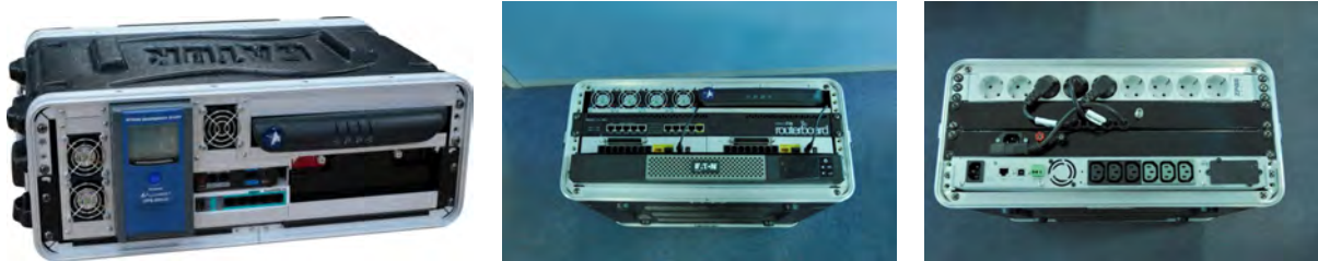
Рис. 4. Переносні (мобільні) вузли зв'язку компанії «Датагруп» (Україна)
