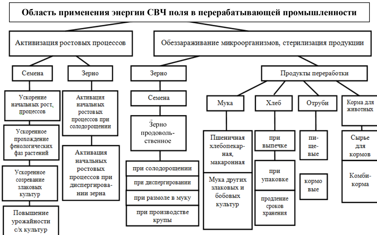
Рис. 4. Систематизация методов обеззараживания зерна и продуктов его переработки
