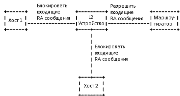
Рис. 3. Принцип работы RA Guard
