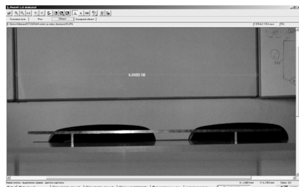
Рис. 2. Измерение объекта в другой плоскости калибровки (1000 мм)
