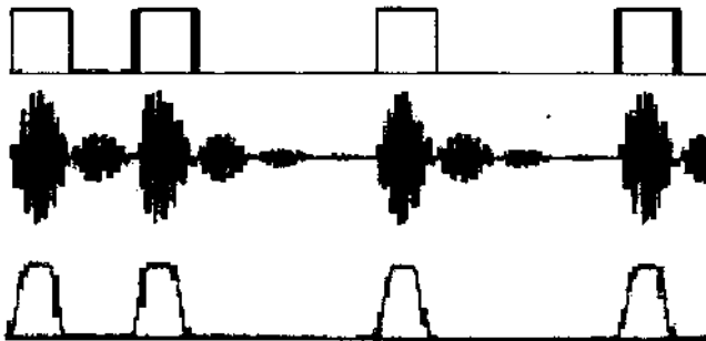
Рис. 3. Осцилограми інформаційного сигналу, нижче – прийнятого сигналу на проміжній частоті телевізійного приймача, ще нижче - на виході детектора телевізійного приймача
