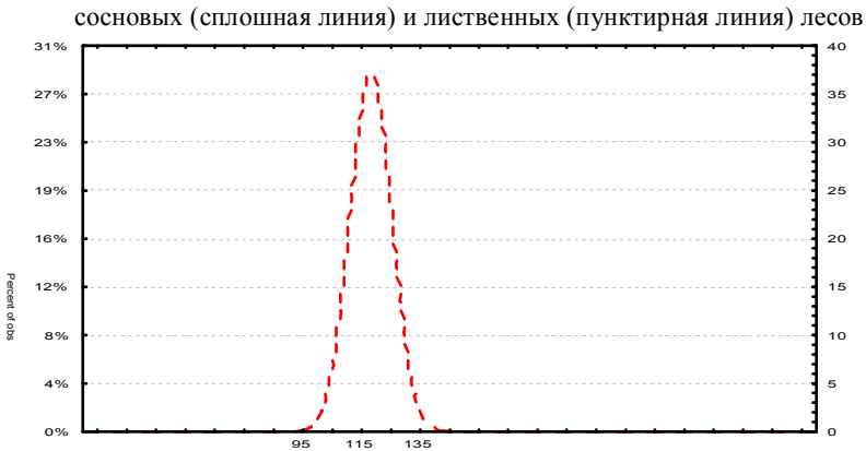
Рис. 5. Графики плотности распределения радиолокационных отражений от сосновых (сплошная линия) и лиственных (пунктирная линия) лесов в миллиметровом диапазоне волн для лиственного леса
