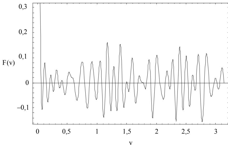
Рис. 1. Синтезированная диаграмма направленности антенной решетки с бинарнофазовым токовым возбуждением
