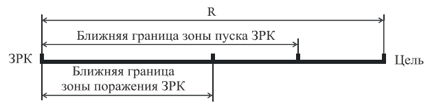
Рис. 1. К определению максимально допустимой длительности сопровождения цели МФ РЛС ЗРК
