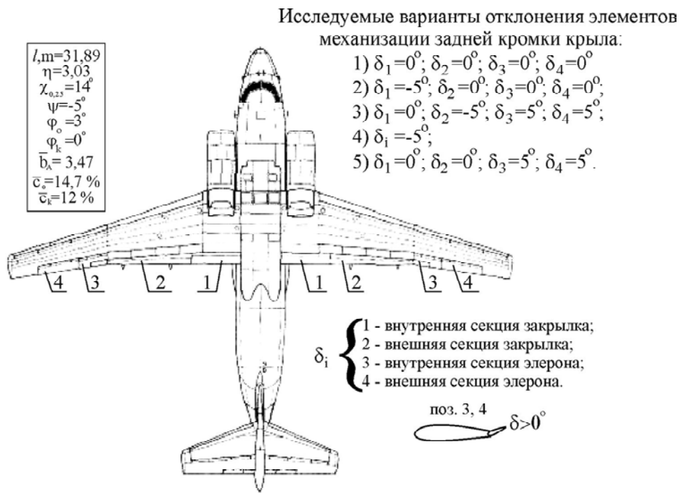
Рис. 1. Исследуемые варианты отклонения механизации задней кромки крыла самолета Ан-74
