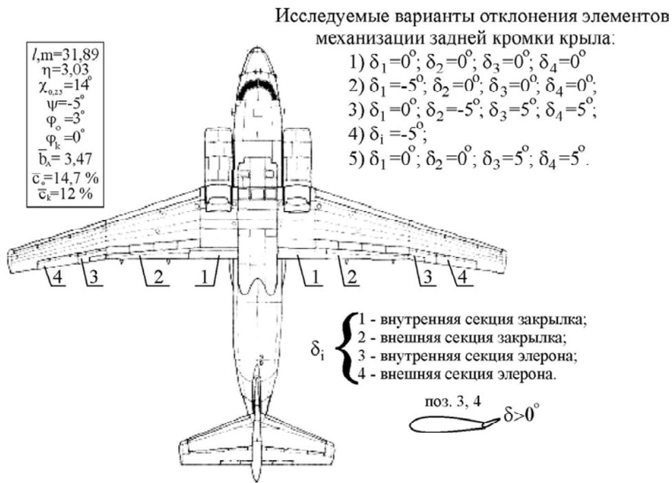
Рис. 1. Исследуемые варианты отклонения механизации задней кромки крыла самолета Ан-74
