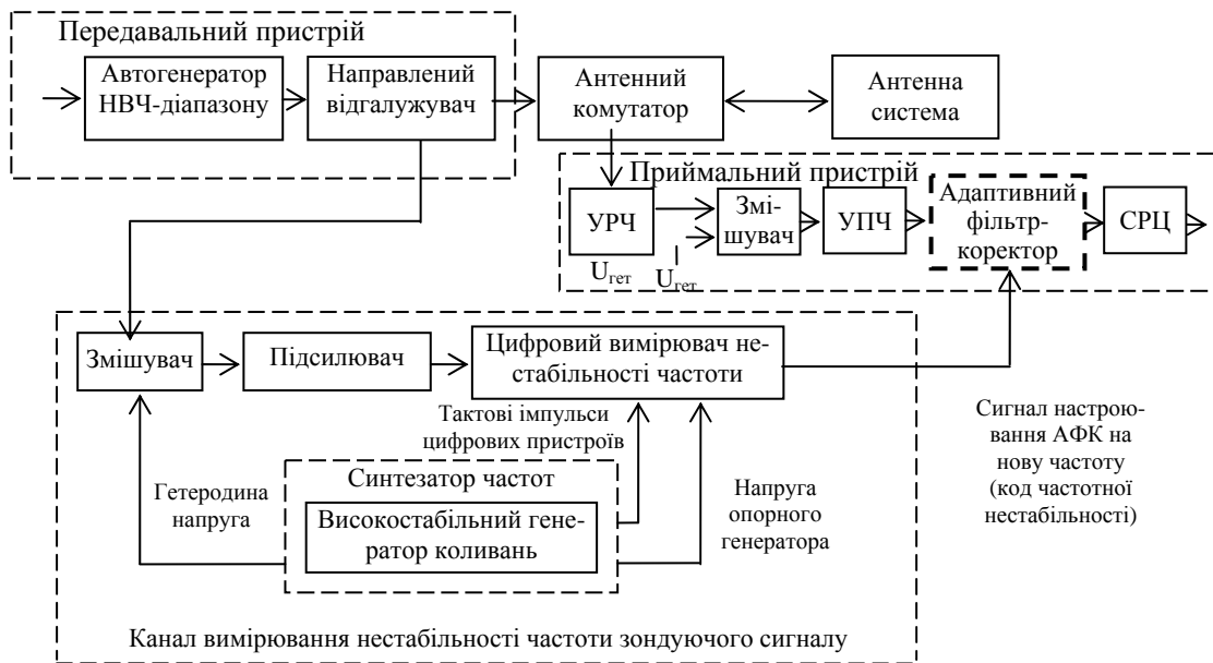
Рис. 2. Структура приймально-передавального тракту захищеного від ПП радіолокатора з низькостабільними генераторними приладами.
