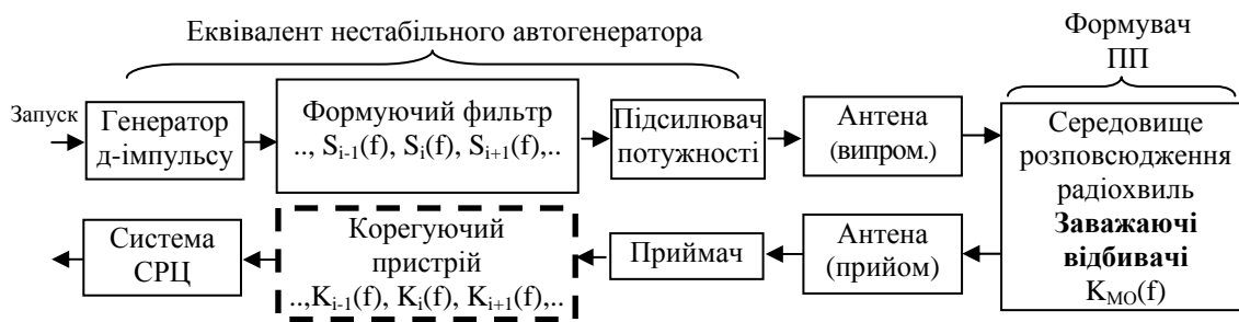
Рис. 1. Еквівалентна схема радіолокаційного тракту
