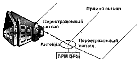
Рис. 1. Принцип формирования переотраженного сигнала
