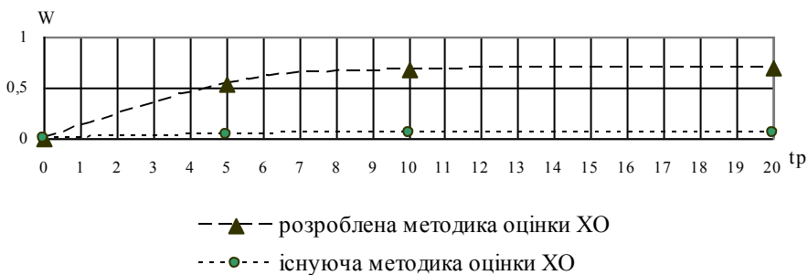
Рис. 2. Значення показників повноти результатів для розробленої та існуючої методики оцінки і хімічної обстановки при аваріях на ХНО
