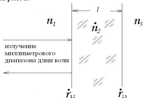
Рис. 2. Схема взаимодействия тонкого полупроводникового слоя с электромагнитным излучением
