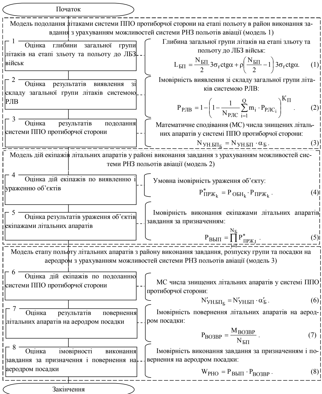
Рис. 1. Блок-схема методики оцінки впливу системи радіонавігаційного забезпечення польотів авіації на результати виконання завдання за призначенням
