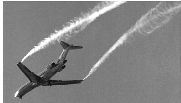
Рис. 1. Вихревой след за самолетом Boeing-727 (Фото NASA, 1974г.)
