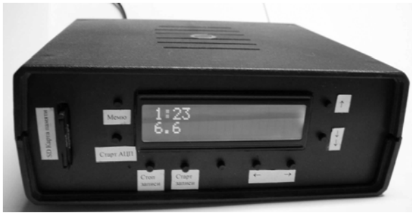
Рис. 3. Внешний вид адаптера сопряжения РЛС с ЭВМ
