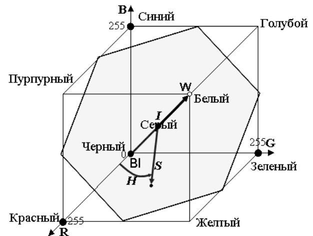
Рис. 1. Геометрическая интерпретация пространства HSI, представленного своим центральным шестигранным сечением, внутри пространства RGB [6]
