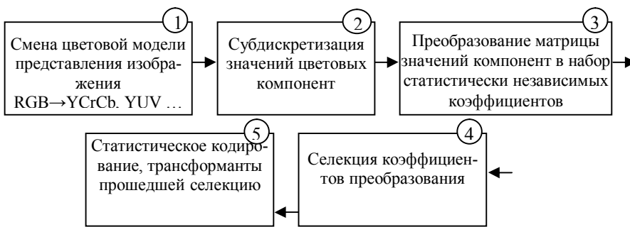
Рис. 3. Блок-схема алгоритма метода сжатия изображений с потерями
