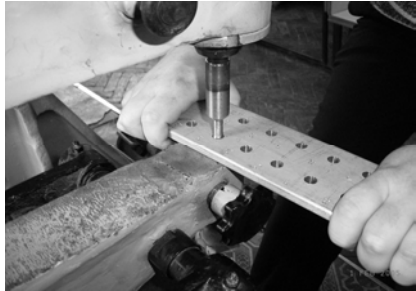
Рис. 4. Дорнование на прессе ПНП-5,5
