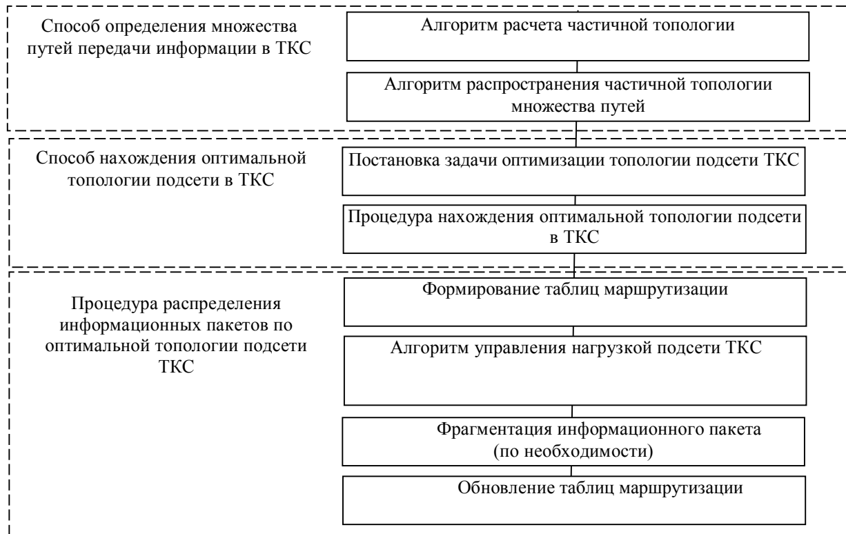
Рис. 1. Структурная схема метода адаптивной маршрутизации цифровой информации о воздушной обстановке
