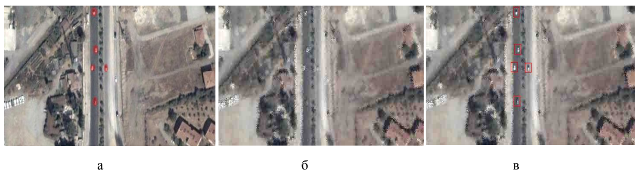
Рис. 2. Обнаружение автомобилей на дороге (а), сжатие изображения с низким качеством (б) и наложение локализованных изображений автомобилей (в) для целей оперативного мониторинга обстановки
