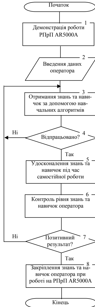
Рис. 3. Блок-схема загального алгоритму підготовки операторів за допомогою програми-імітатора РПрП AR5000A
