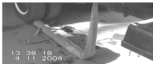
Рис. 6. Експериментальні дослідження з моделлю еластичного резервуара (ємністю 30 л)
