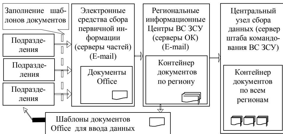
Рис. 3. Схема сбора первичной информации о техническом состоянии, режимах и результатах эксплуатации образцов ЗР(РТ)В
