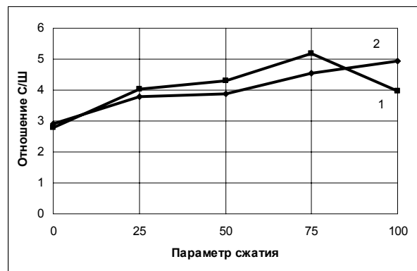
Рис. 5. Зависимость отношения сигнал/шум от параметра сжатия: 1 – теоретическое значение, 2 – экспериментальное значение
