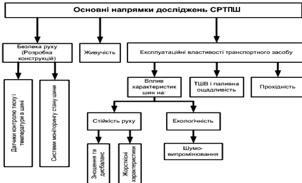
Рис. 3. Систематизація напрямків досліджень систем регулювання тиску повітря в шинах транспортних засобів
