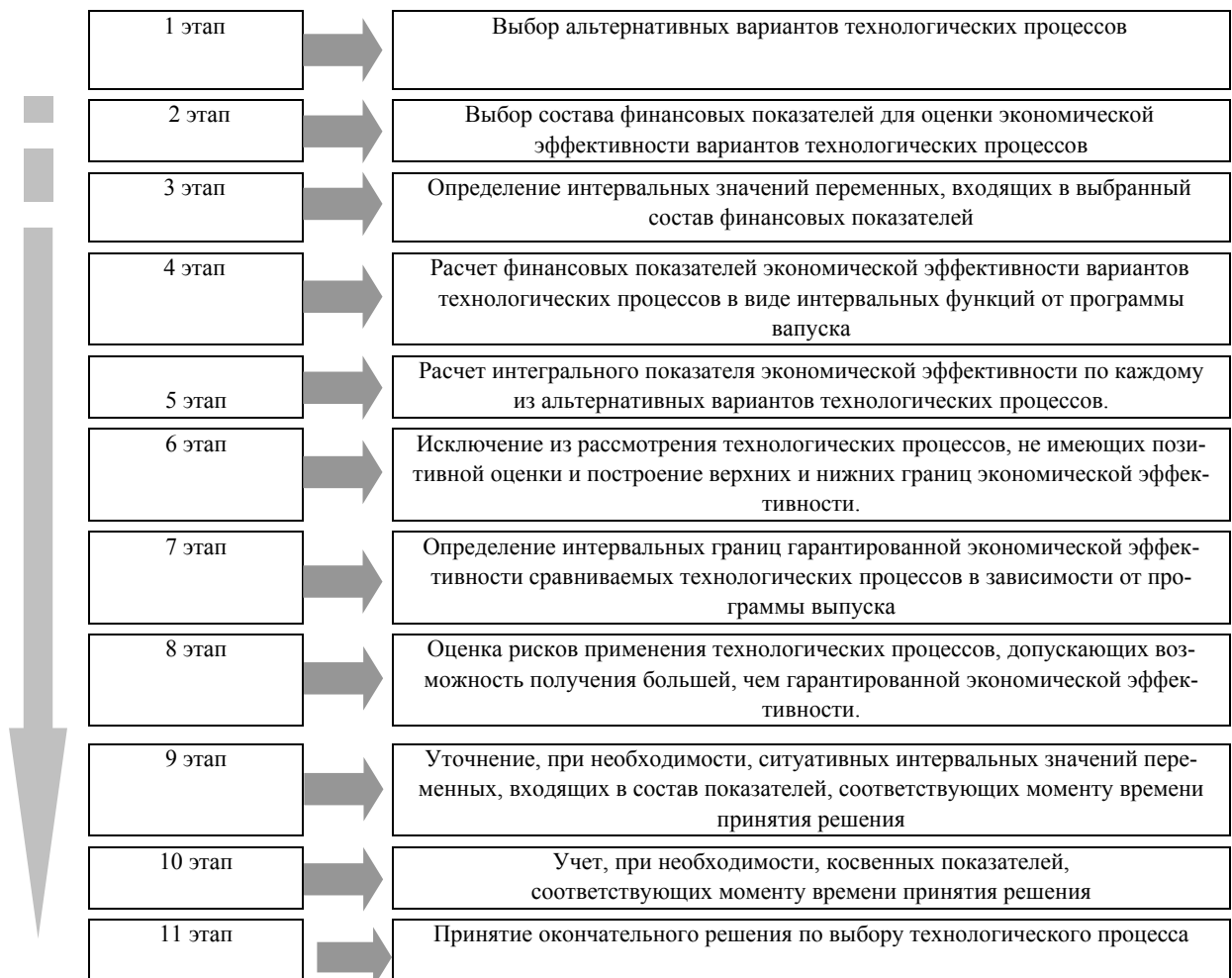
Рис. 2. Процедура определения границ эффективности вариантов технологических процессов в условиях неопределенности исходных данных
