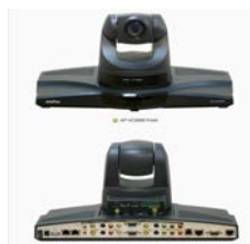
Рис. 3. Варианты настольных комплексов ВКС для оперативного уровня системы
