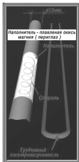
Рис. 5. Конструкция ЭН блока ТЭНБ-90П380И1
