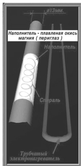
Рис. 5. Конструкция ЭН блока ТЭНБ-90П380И1
