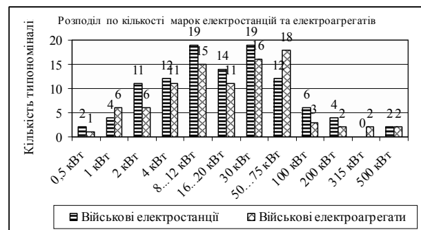
Рис. 5. Розподіл по кількості марок електростанцій та електроагрегатів загальновійськового призначення та військової техніки
