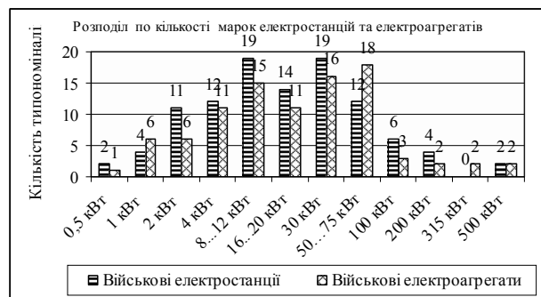
Рис. 5. Розподіл по кількості марок електростанцій та електроагрегатів загальновійськового призначення та в комплексах озброєння та військової техніки
