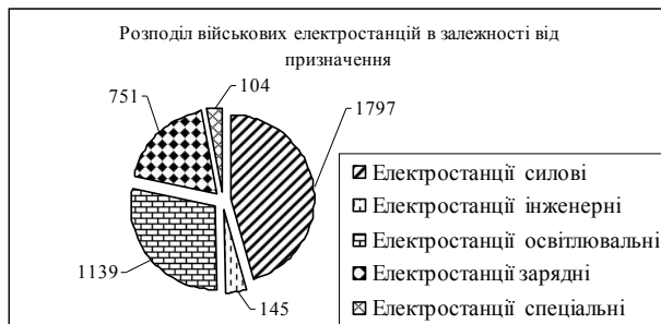
Рис. 1. Розподіл військових електростанцій в залежності від призначення
