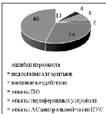
Рис. 2. Распределение основных причин сбоев в работе ИУС АЭС
