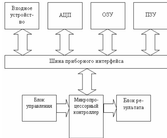
Рис. 1. Схема мультиметра с применением цифровой обработки сигналов
