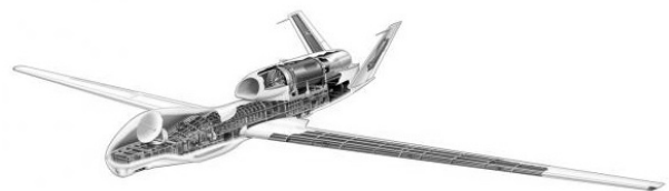
Рис. 1. Компоновочная схема БПЛА RQ-4B
