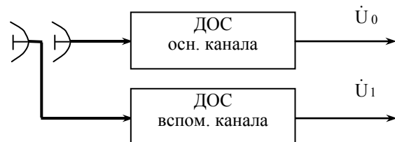
Рис. 2. Обобщенная схема антенной системы АК
