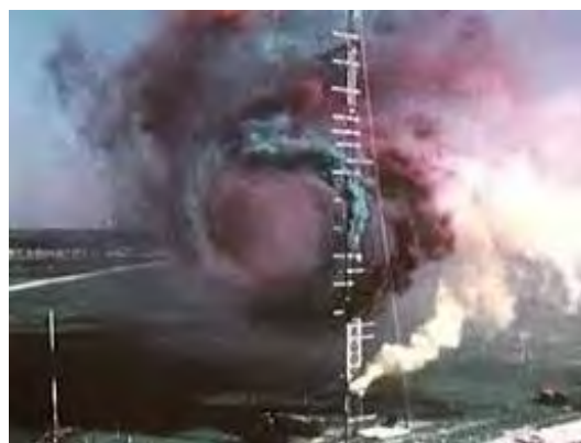
Рис. 6. Исследования характеристик вихревого следа с помощью стационарных вышек
