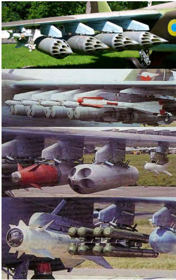
Рис. 1. Варіанти загрузки АЗУ на штурмовик Су-25
