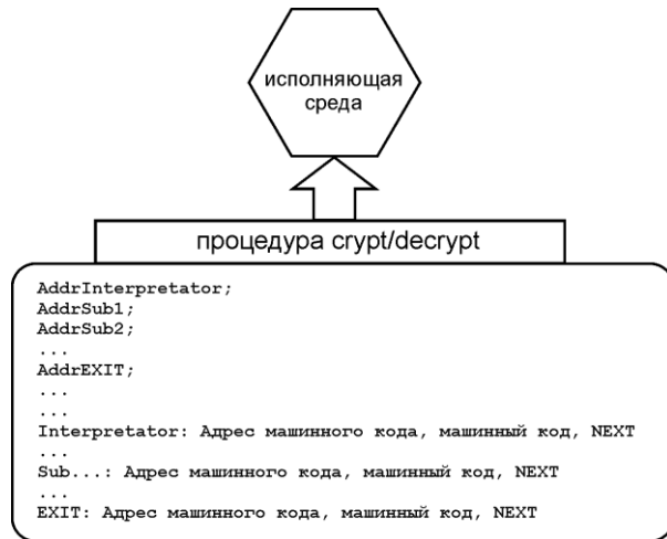
Рис. 2. Блок-схема виртуальной машины с динамическим шифрованием на лету
