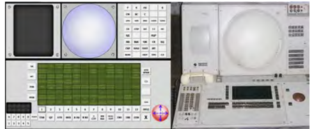
Рис. 1. Зовнішній вигляд структури АРМ у складі ІМ та реального РМ-10
