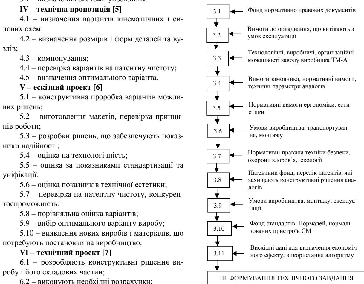
Рис. 1. Граф інформаційного забезпечення процесів конструювання при опрацюванні технічного завдання
