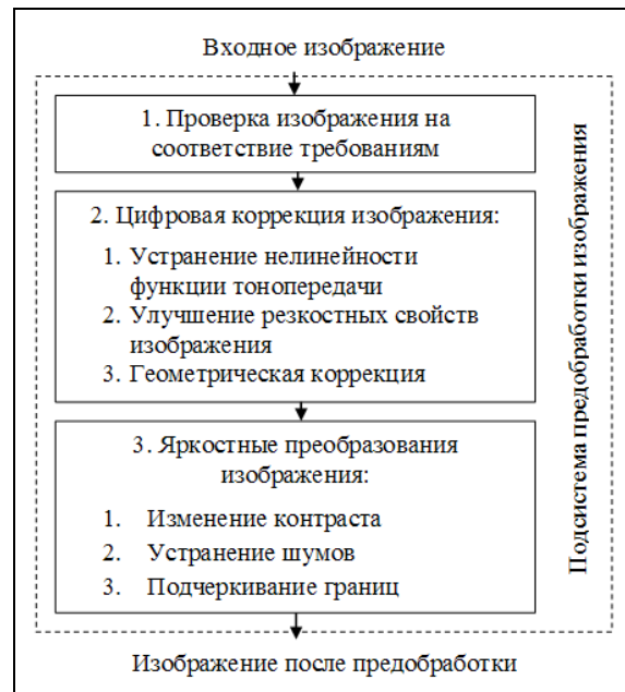
Рис. 2. Подсистема предобработки изображения
