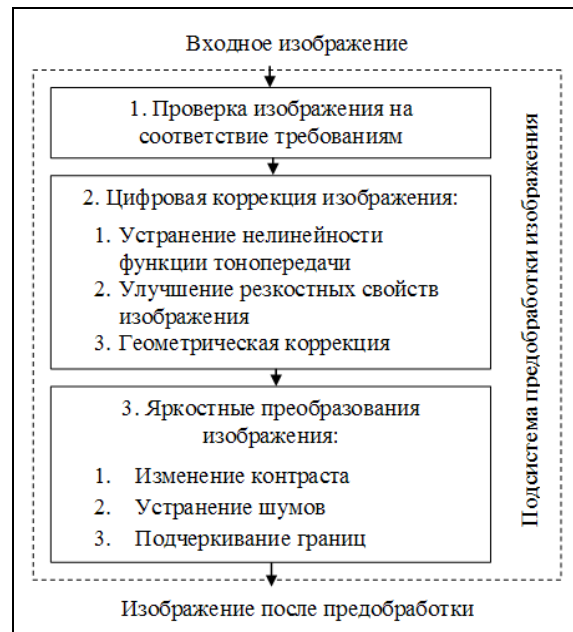
Рис. 2. Подсистема предобработки изображения
