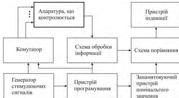
Рис. 1. Схема індикації відмов пасивних елементів
