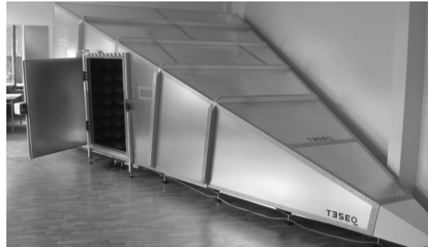
Рис. 2. Тестовая ГТЕМ-камера TESEQ GTEM 1500 с открытой дверцей
