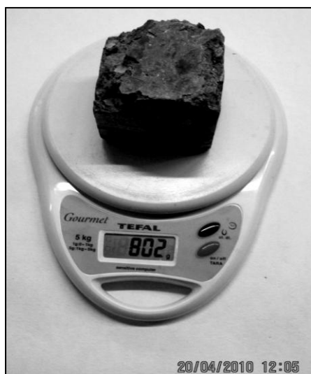
Рис. 1. Определение величины потери массы исследуемого образца после проведения опыта по влиянию знакопеременных температурных воздействий
