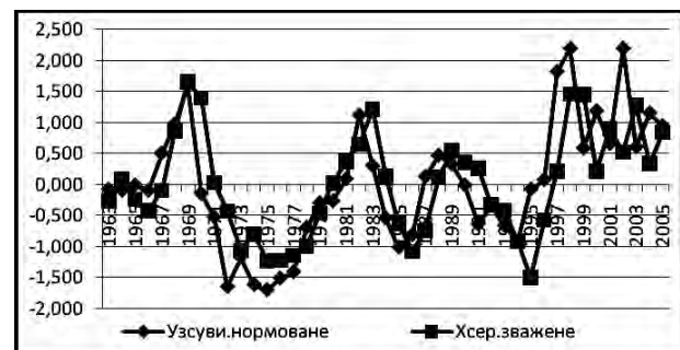
Рис. 2. Незалежний фактор, розрахований як середнє зважене, і залежний показник для прогнозування зсувних процесів Південного берега Криму для моделі РОЗС
