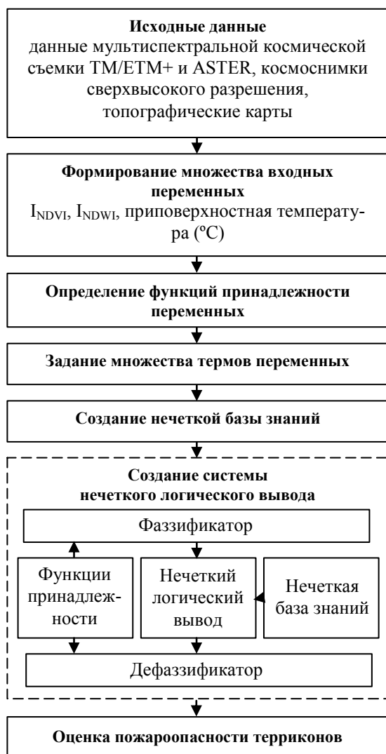
Рис. 2. Схема процесса оценки пожароопасности терриконов на основе нечеткого логического вывода
