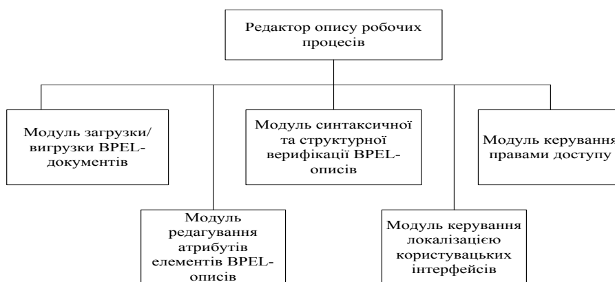
Рис. 2. Основні архітектурні блоки редактора описів робочих процесів
