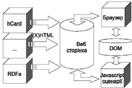
Рис. 4. Модель взаємодії користувача з мікроформатами на базі Javascript та DOM
